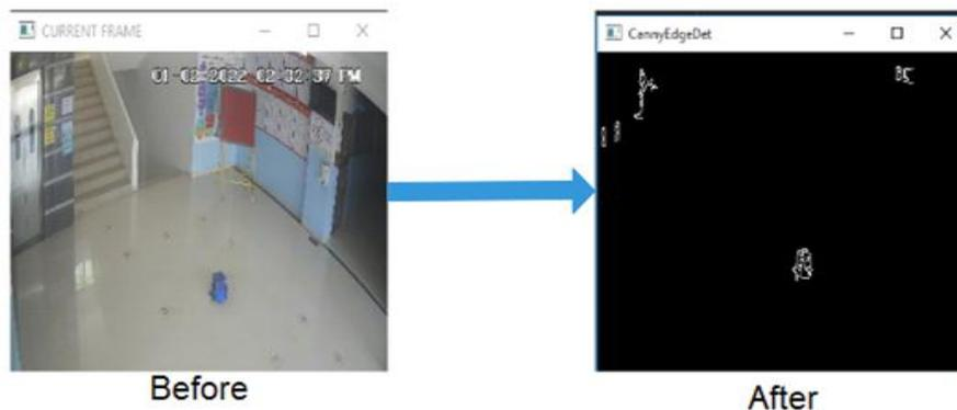
Fig.4. Canny Edge Detection
